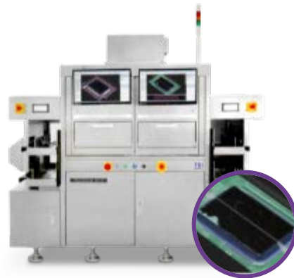
TR7900Q SII-R 彈匣 & 載板 + 複判站 3D Semi AOI 潔淨室 class 100
